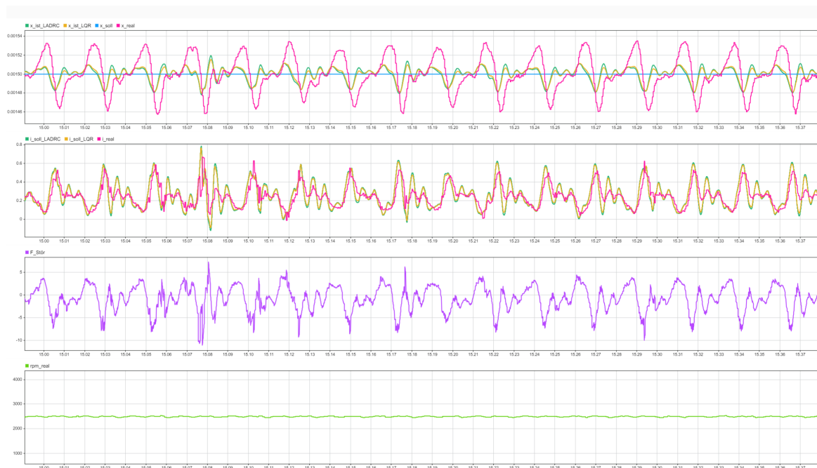
Abbildung 5.35.: Folgeverhalten bei 2500 RPM und 1,5 mm Soll-Position unter R + 12,5\% , L - 15\% und K_F - 10\%
