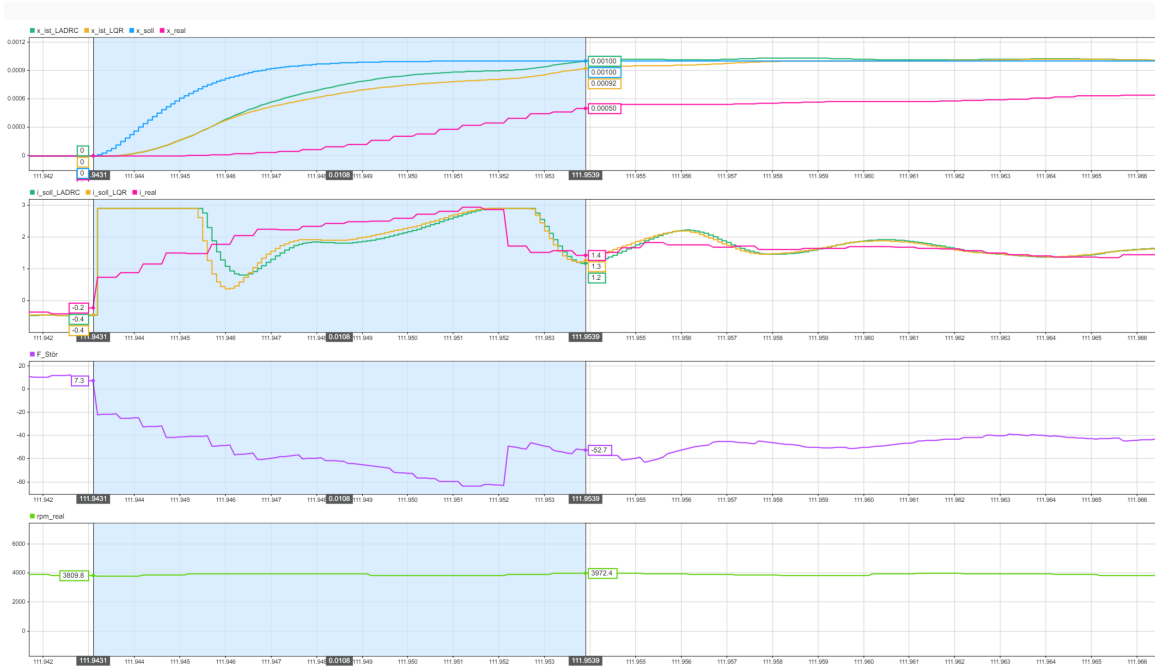
Abbildung 5.28.: Folgeverhalten bei 4000 RPM und 0 bis 1 mm Soll-Position
