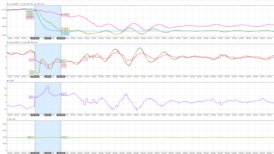
Abbildung 5.29.: Folgeverhalten bei 4000 RPM und 1 bis 0,5 mm Soll-Position
