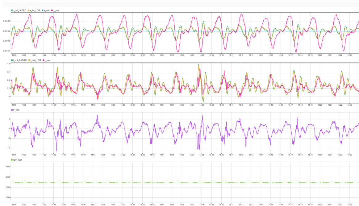
Abbildung 5.34.: Folgeverhalten bei 2500 RPM und 1,5 mm Soll-Position unter -10\% Kraftkonstantenabweichung
