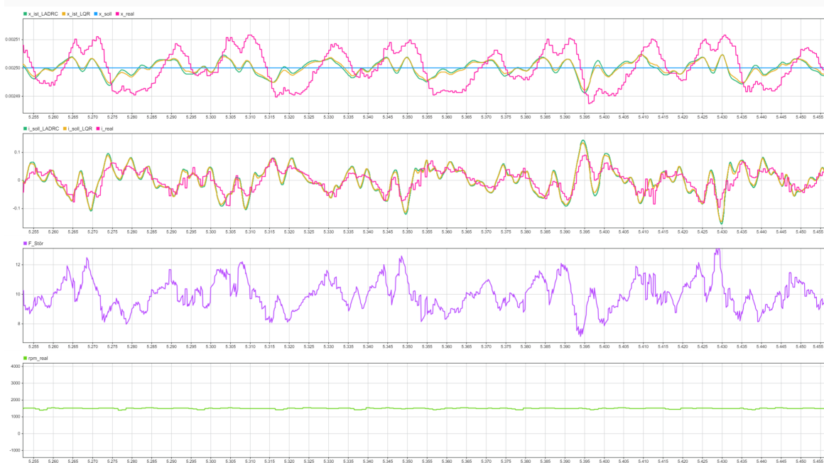
Abbildung 5.9.: Folgeverhalten bei 1500 RPM und 2,5 mm Soll-Position
