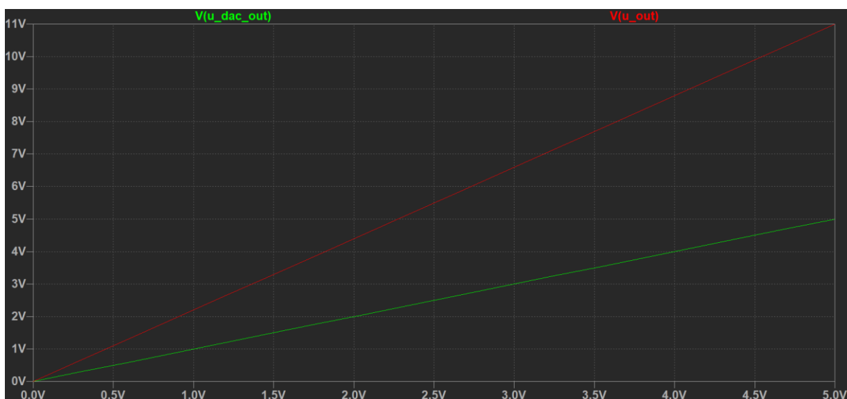
Abbildung 4.15: DAC-Spannung vs. Netzteil positiv Ausgangsspannung
