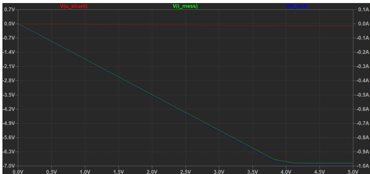
Abbildung 4.19: Strombegrenzung Netzteil negativ
